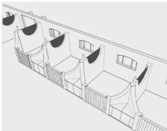
Figur 41. "Burspråksfront" är en "ny" form på boxfronter som ger en god överblick för hästen. I ritningen till höger har man nyttjat boxfrontens veck för ett specialdesignat skåp för att till exempel hänga täcken i. "Renhållningslinjen" blir därmed rak – det är annars besvärligt att sopa och hålla hörnen mellan den utskjutande delen av fronten ren.
