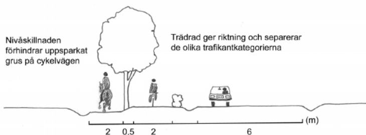
Figur 35. Exempel på utformning av kombinerad rid-, bil- och kombinerad cykel- och gångväg.
