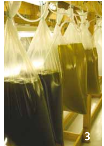
Billede 1. Fotobioreaktor, kontinuerligt opdrætssystem i cylindre til mikroalger, til store mængder.
