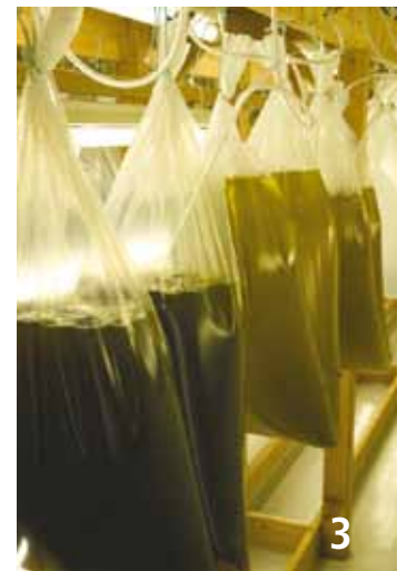
Bilde 1. Fotobioreaktor, kontinuerlig dyrkingsystem i sylindrer for mikroalger, for store mengder.
