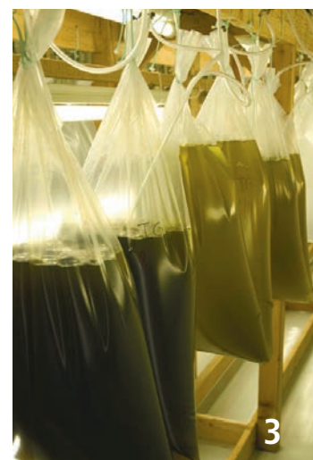
Bild 1. Fotobioreaktor, kontinuerligt odlingsystem i cylindrar för mikroalger, för stora volymer.
